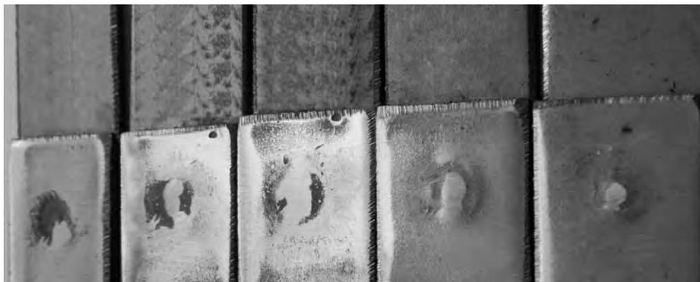
Рис. 11. Характер деформации лицевых поверхностей свариваемых деталей с уменьшением суммарной энергии  $Q_{\Sigma}$  от полной (на первом образце) на 20, 40, 60 и 80 % соответственно
