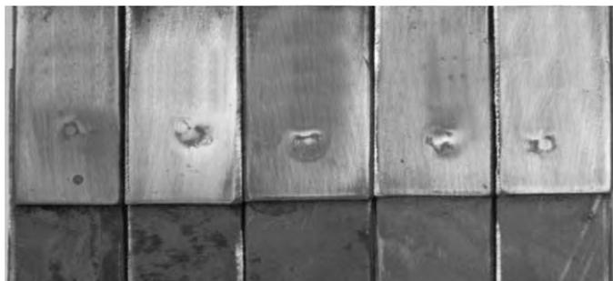
Рис. 3. Деформации лицевых поверхностей изделий со стороны электрода с увеличенной площадью контакта при КРС
