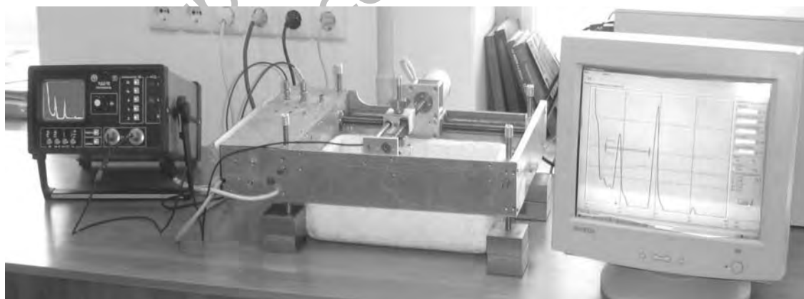
Рис. 1. Лабораторный аппаратно-программный комплекс для проведения автоматизированного ультразвукового контроля
