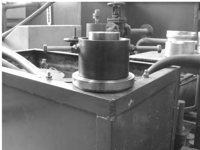
Рис. 3. Общий вид экспериментальной установки с водоохлаждаемым стержнем диаметром 65 мм
