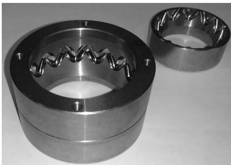
Рис. 1. Кулачки, образующие беговую дорожку СРП
