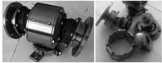
Рисунок 2 — Сферическая передача с незакрепленными роликами: а — механизм в сборе; б — основные узлы
