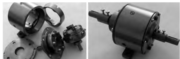
Рисунок 3 — Редуктор на основе сферической прецессирующей передачи: а — основные узлы; б — редуктор в сборе
