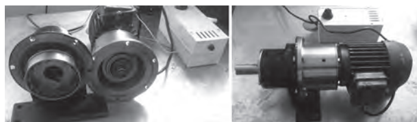
Рисунок 4 — Мотор-редуктор на основе сферической прецессирующей передачи: a — основные узлы; б — механизм в сборе
