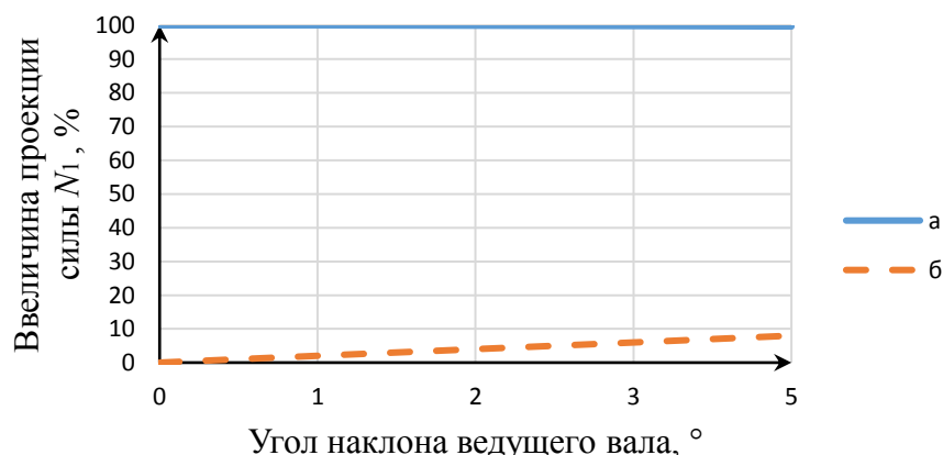
Рис. 5. График зависимости проекции силы N_1 на ось Y от величины угла наклона ведущего вала \alpha :
