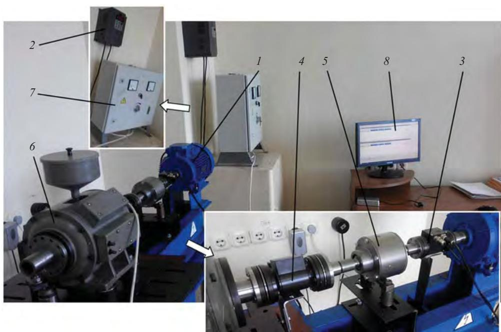
Рис. 4. Редуктор с двухзвенной СРП на испытательном стенде: 1 – асинхронный электродвигатель; 2 – частотный преобразователь; 4, 5 – датчики крутящего момента и частоты вращения; 5 – испытываемый редуктор; 6 – порошковый тормоз; 7 – блок управления порошковым тормозом; 8 – ПЭВМ
