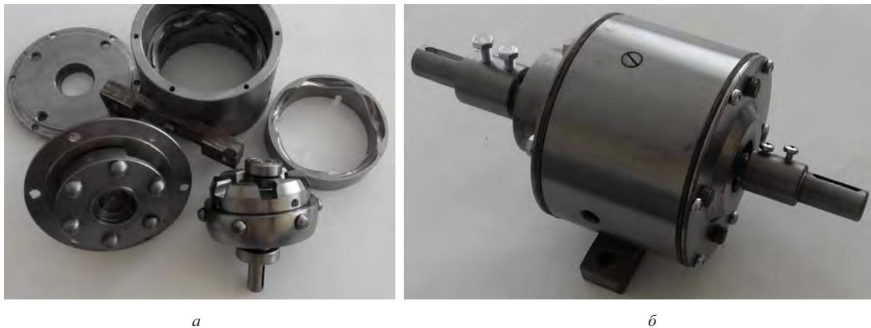
Рис. 3. Экспериментальный образец редуктора с двухзвенной СРП:
