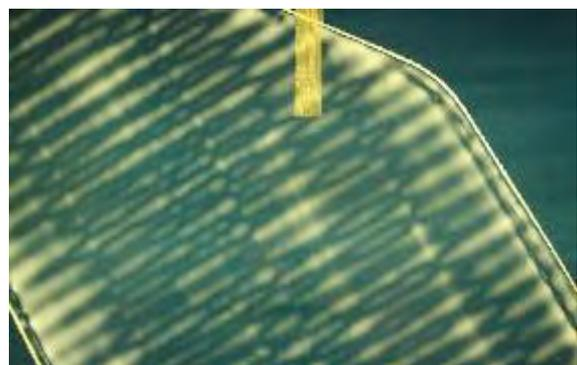
возникающего двулучепреломления позволяют оценить величину и распределение этих напряжений. Использование современной цифровой техники в качестве фоторегистрирующего устройства позволяет получать картину, иллюстрирующую распределение напряжений вдоль поверхности стекла.
