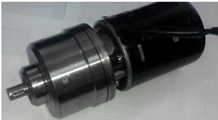
Рис. 7. Экспериментальный образец СРП: а – детали редукторного узла; б – мотор-редуктор
