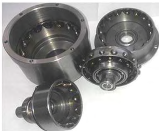
Рис. 7. Экспериментальный образец СРП: а – детали редукторного узла; б – мотор-редуктор
