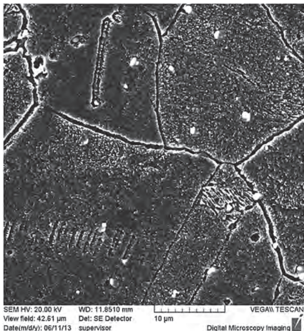
Рис. 4. Структура литой классической бронзы БрХ
