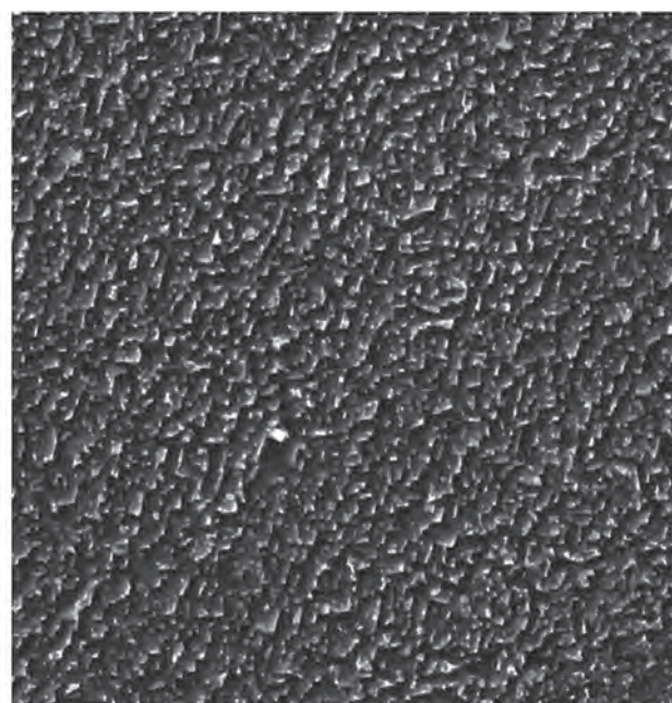
Рис. 6. Структура литой классической бронзы БрХ: a – закалка + старение; б – закалка + пластическая деформация, \epsilon = 60\% + старение
