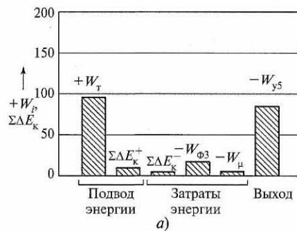
Рис. 7. Диаграмма баланса энергии в коробке передач при переключении со второй на третью передачу с нулевым (а) и положительным (б) перекрытиями
