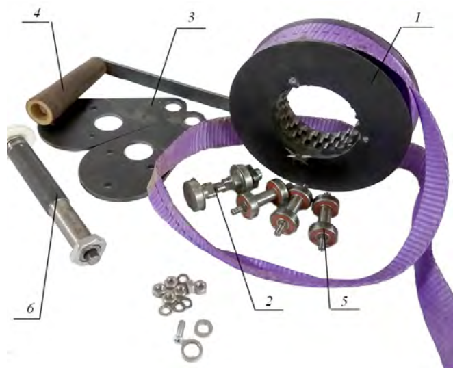
Рис. 5. Детали ручной лебедки, смонтированной на основе эксцентриковой передачи с числом контактных пар в зацеплении, равном 3: 1 – барабан, состоящий из набора зубчатых колес; 2 – эксцентрик с подшипниками, запрессованными в крышки; 3 – реборда; 4 – ручка; 5 – вал с подшипниками; 6 – фиксирующий механизм
