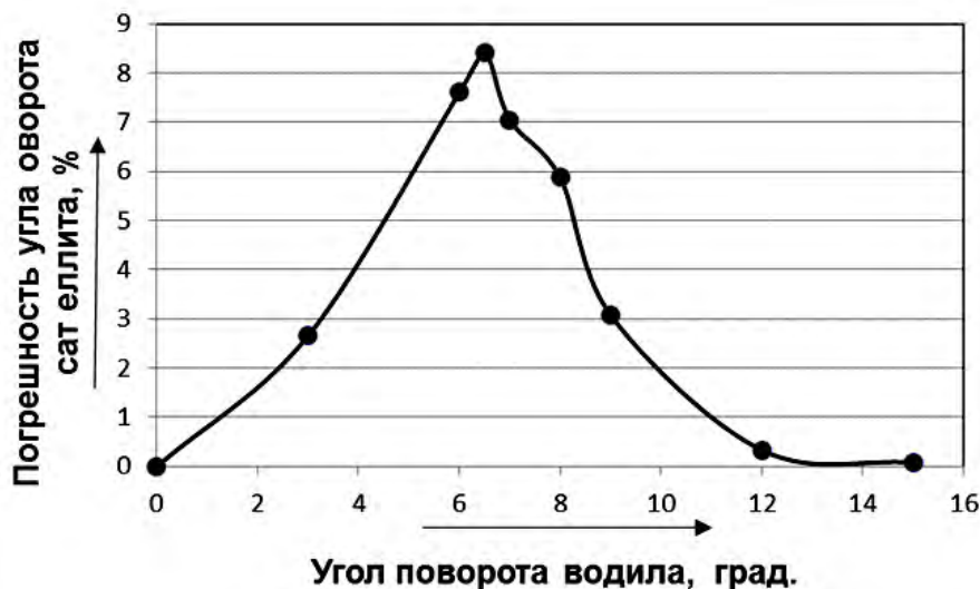
Рисунок 6 – Изменение погрешности угла поворота сателлита при максимальном числе цевок центрального зубчатого колеса
