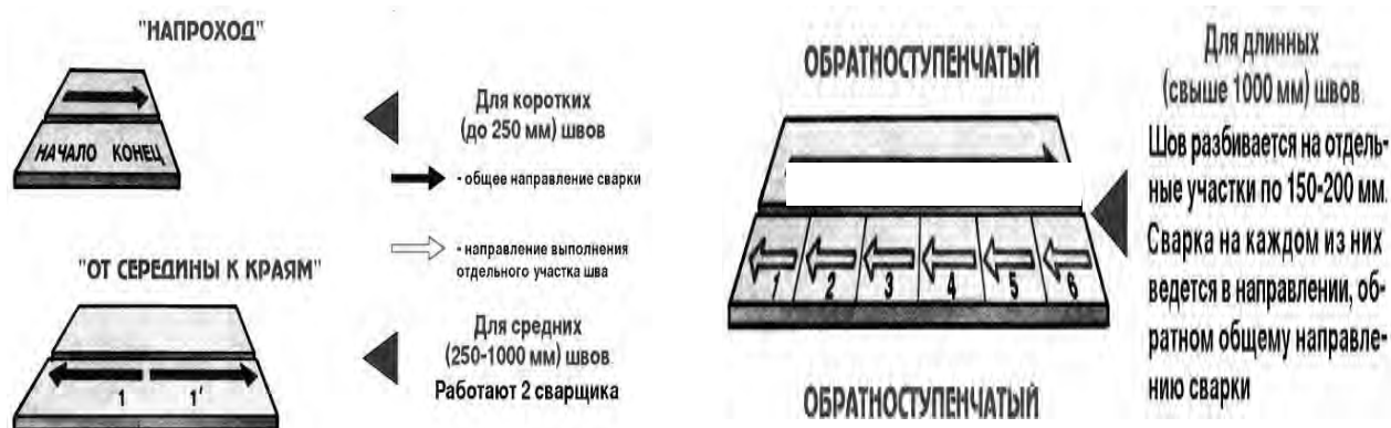
Рисунок 2 – Последовательность выполнения сварных швов
