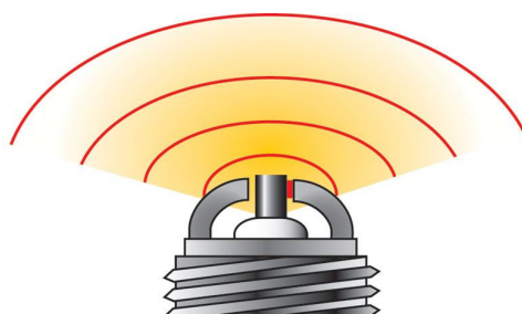
Рисунок 1. – Фронт распространения пламени в многоэлектродной свече зажигания.
