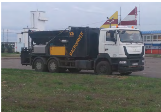
Рис. 1. Оборудование VSS Macropaver 12B
