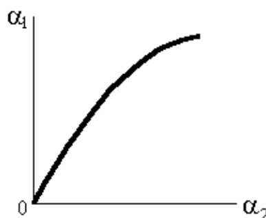
Рисунок 12.2 – Экспериментальный график зависимости углов поворота управляемых колес автомобиля
