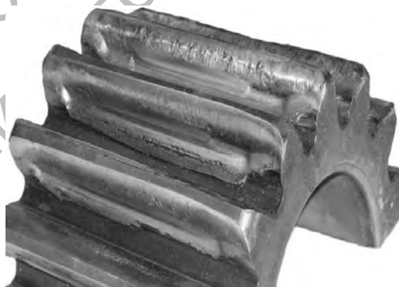
Рис. 3. Результат прогрессирующего питтинга зубьев ведущей шестерни колесомоторного блока локомотива ЧМЭ-3 ( m = 10 мм, z = 15 )
