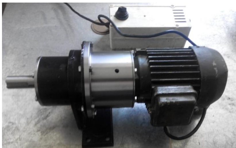
Рис. 1. Экспериментальный образец мотор-редуктора
