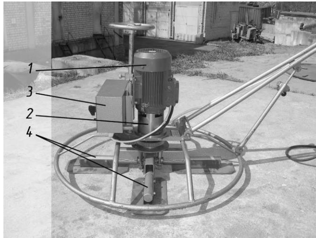
Рис. 10. Общий вид машины заглаживающей СО-170 с прецессионным мотор-редуктором: 1 – электродвигатель; 2 – прецессионный редуктор; 3 – электрооборудование; 4 – рабочий орган
